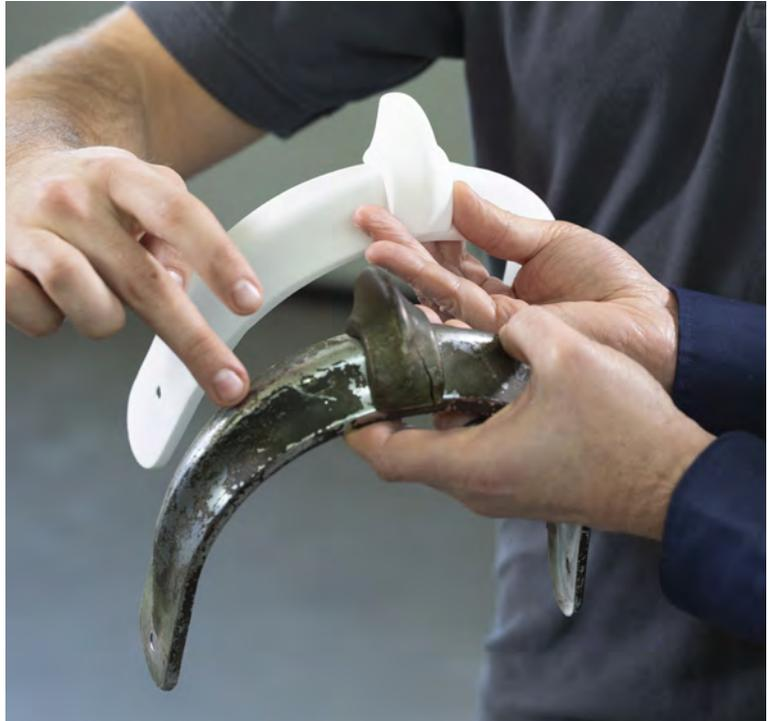
*Vor der Verchromung wird verglichen: Entspricht das neu gedruckte Kunststoffteil, die Stoßstange einer alten Vespa, dem Original in Form, Aussehen, Größe und anderen Details?*
