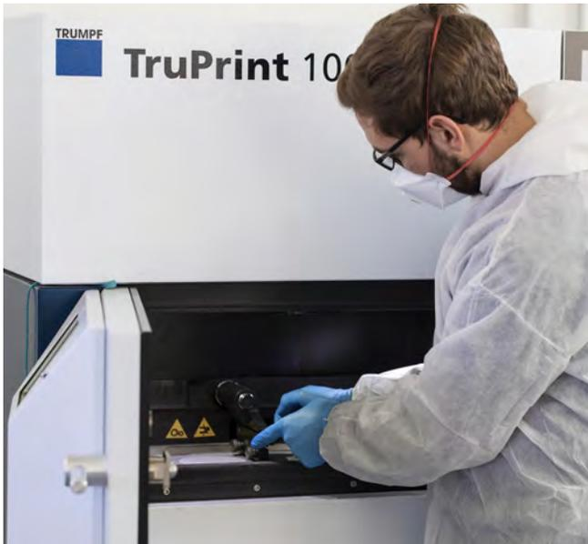
*Der metallische 3D-Drucker wird auf seinen Einsatz vorbereitet: Hier entstehen additiv gefertigte Teile, die den konventionell gefertigten in puncto Dichte ebenbürtig sind.*
