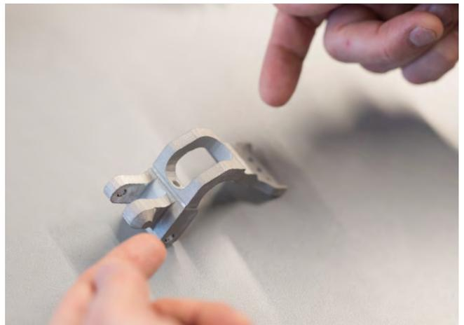
*Mit dem ZEISS COMET entsteht ein 3D-Modell, das das gescannte Bauteil mit einer exakten Punktwolke anzeigt und damit geprüft werden kann.*
